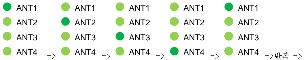
<그림 12> 안테나 채널 표시용 LED
