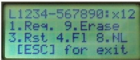
最初の行には遠隔管理を遂行するIDとCHが表示されている。左側の「L」はLOG関連作業を示す。以下にはDMと一緒に押す各数字Keyの機能の説明である。
