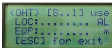
実際の動作が行われる場合に設備側から送るDataを持続的に受信する場合には3行目の右側に「\*」が表示され、この表示は100ms以内に更新されない場合消えるので、設備との持続的な通信をしているかどうか確認できる。
